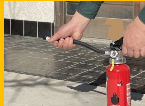
Apunte la boquilla al origen del fuego y apriete la palanca.
